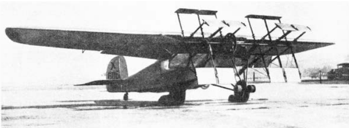
Рис. 14.5. Американский самолет «Сайклоджайро» (~1930 г.) с напоминающей гребное колесо конструкцией, получившей название «циклоидный пропеллер».
