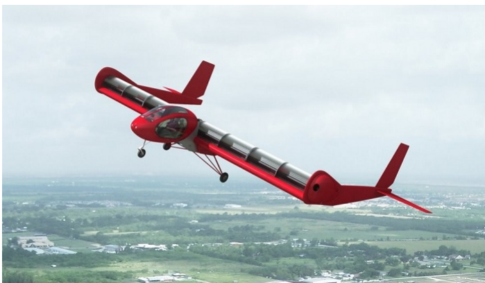
Рис. 14.5. Американский самолет «Сайклоджайро» (~1930 г.) с напоминающей гребное колесо конструкцией, получившей название «циклоидный пропеллер».
